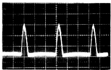
26. IC601 Pin 21 (E-PCB) 4.1V, 20 \mu s / Div
