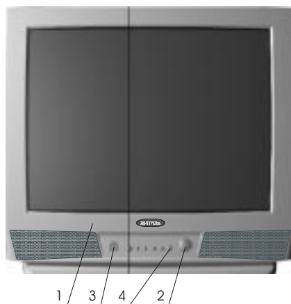
Рисунок 1.11 - Устройство управления телевизоров “Витязь 54 CTV 6743/6743T” VIKING
